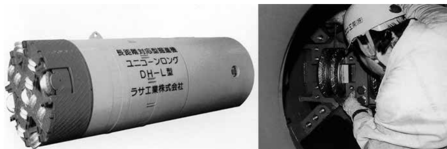
ビット交換状況
