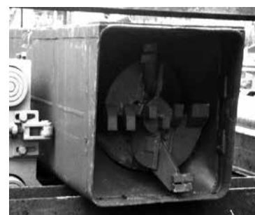
写真-3 オーガ式矩形掘削機 □800mm
