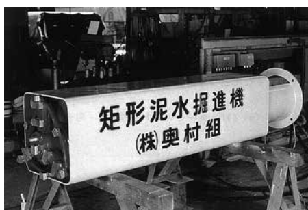
写真-2 泥水式矩形掘削機 □500mm
