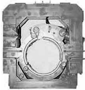
方向修正装置 (パワーレンチ)
