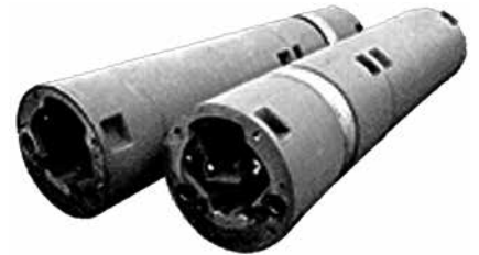
写真-1 後続管の曲線誘導装置事例 (出典：マイクロ工法協会)
