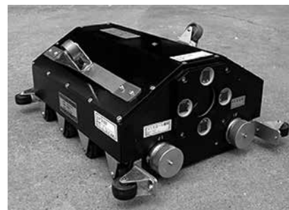
写真-4 プリズムユニット (中間)
