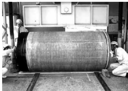
写真-3 一点荷重試験状況
