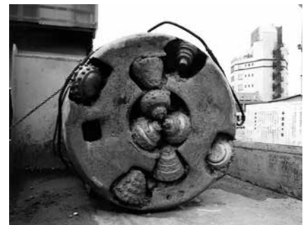
写真-2 異常磨耗した掘進機
