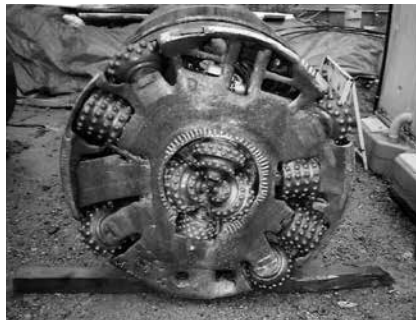
写真-3 異常磨耗した掘進機面板
