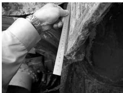
写真-2 掘進機フード部がラッパ状に開き歪に変形している
