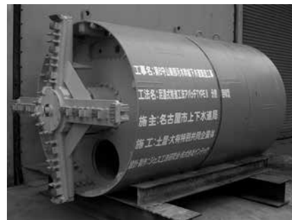
写真-1 アパッチ工法掘進機 TypeⅡ (分解回収型)
