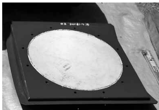
写真-1 切削可能な土留め壁と鋼製枠
