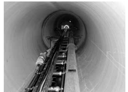
写真4 管内ロールコンベアレール上の CCD カメラセンサー
