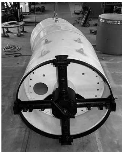
写真-1 整備中の掘進機一方向修正中
