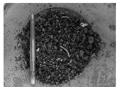
写真-3 鉄筋コンクリート管本体部破碎状況
