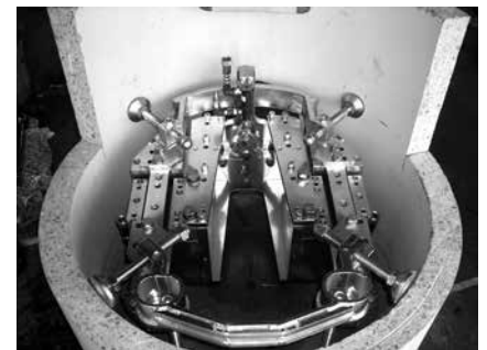
写真-2 破碎機引込装置
