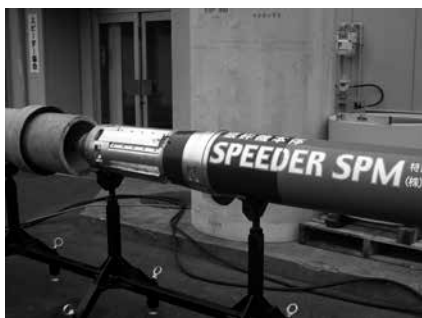
写真-1 スピーダー SPM 破碎機
