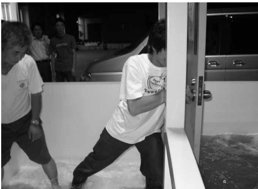
写真-1 地下浸水時のドアを押し開けての避難実験
