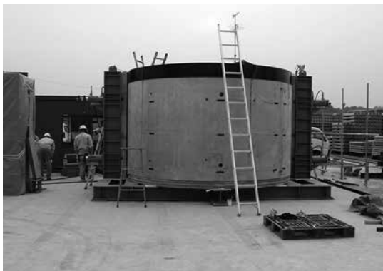
写真-3 呼び径3500実物大モデル外圧試験状況
