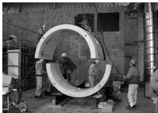
写真-1 呼び径2000縮小モデル 組立性試験状況
