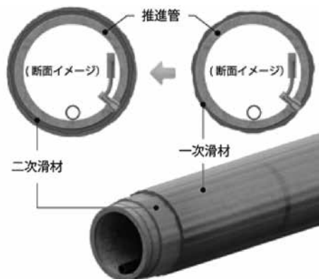
図-2 推進力低減装置R-BSシステムの概念図
