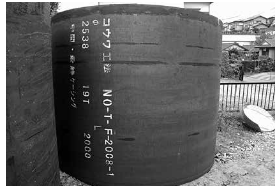
写真-1 φ2,500mm鋼製ケーシングの外観
