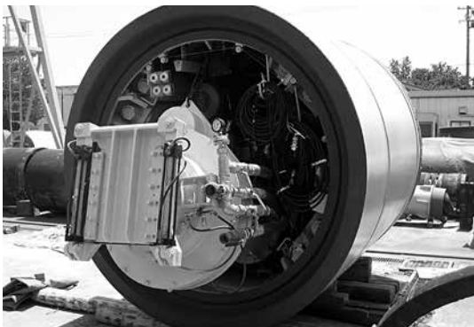
写真-3 土圧式掘進機 スクリュコンベヤ（軸スクリュ+正面ゲート）
